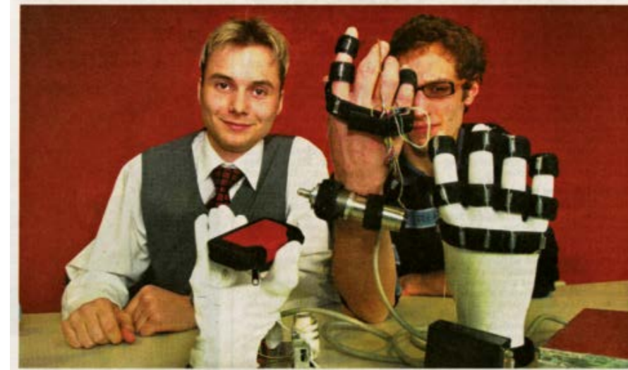
Ein Handschuh, der seinen Träger spüren lässt, was der angeschlossene Roboter fühlt. Der Prototyp, den der Verein „wir forschen“ entwickelt hat, könnte eine Basiserfindung für den Einsatz von Maschinen in Industrie und Medizin sein. Diese und 680 weitere Ideen und Produkte für alle Lebensbereiche präsentiert die 57. internationale Fachmesse lena — Ideen-Erfindungen-Neuheiten — vom 3. bis 6. November im Nürnberger Messezentrum. (Reportage Seite 3) Foto: Karlheinz Daut
